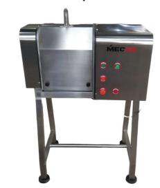
Cabezal de limpieza recubierto con tapas desmontables
